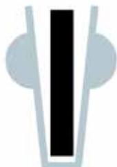
Die Mantel-Dichtungskonstruktion liefert uneinheitliche Ergebnisse zwischen den beiden Materialien. Außerdem wird es mit der Zeit kriechen, kaltfließen und undicht werden.
