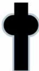
Das PTFE-gepropfte Elastomer in einer Tuf-Flex®-Dichtung hält den I.D. ohne Nachziehen oder Leckage.
