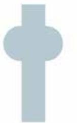
Eine massive PTFE-Dichtung vom Typ I wird unter SIP-Bedingungen garantiert versagen. Sie kriechen, fließen kalt und werden bei  $\Delta T$  undicht.
