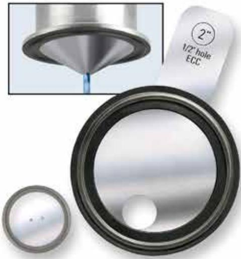
Unser innovatives Blendenortiment umfasst eine vollständige Auswahl aus massivem Tuf-Steel®-316L-Edelstahl, die in Standard- und Laschen-Tri-Clamp-Ausführung geformt sind und mit einer exzentrischen oder konzentrischen Bohrung versehen werden können. Vertikale Styles, die trichterförmig sind und eine optimale vertikale Entwässerung ermöglichen, sind ebenfalls erhältlich. Kondensatableiter-Miniblenden sind eine Alternative zur standardmäßigen Kondensatableiter-Technologie.
